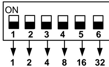
**Ejemplo :** Configuración de el repetidor como **01**
