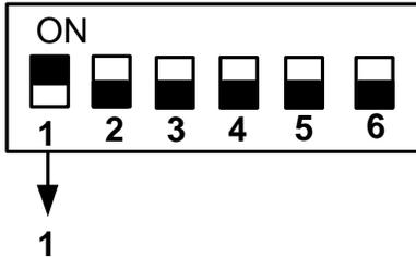
Si el House ID 1 esta conectado con el repetidor ID 01 entonces :
